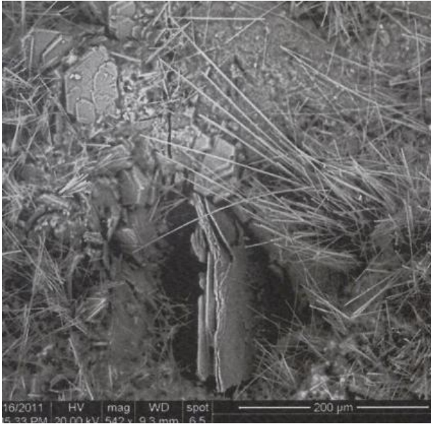
Fig 7: Utfällningar på sprickyta. Provet helt nedsänkt i havsvatten under 28 månader. Sprickvidd 0,4 mm.
