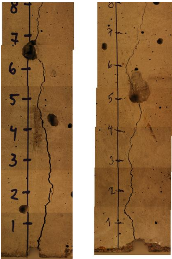
Fig 2: Exempel på spricka före exponering. Vänstra bilden, sprickvidd 0,4 mm.
